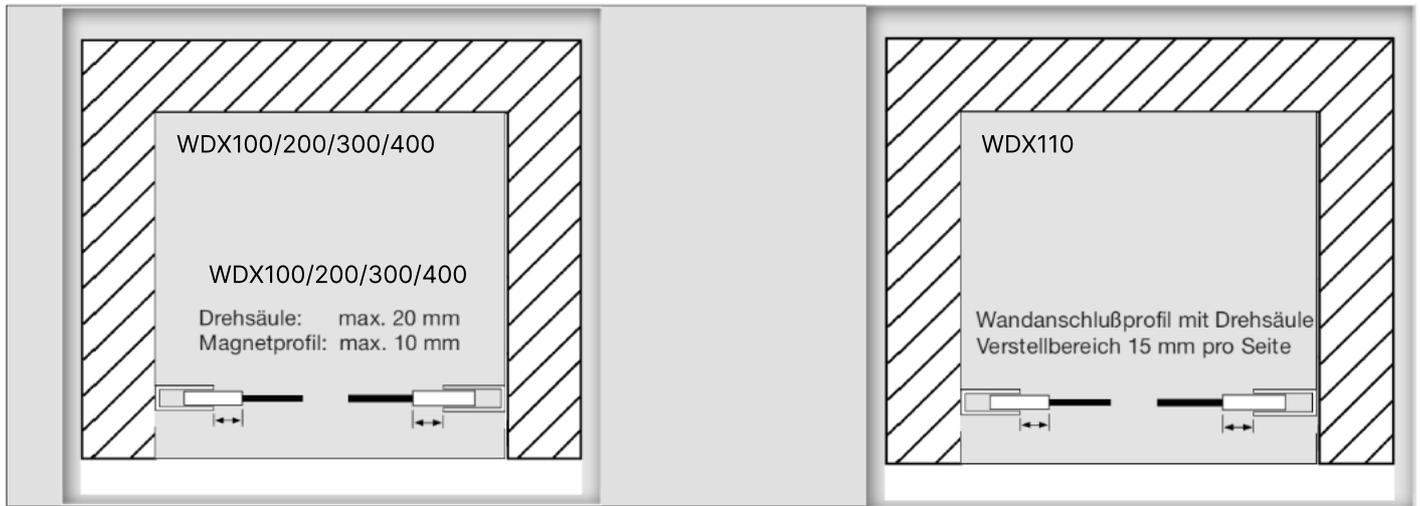
Montage Fronteinstieg mit Seitenteil / Eckeinstieg / MOUNTING FRONT ENTRY / CORNER ENTRY
